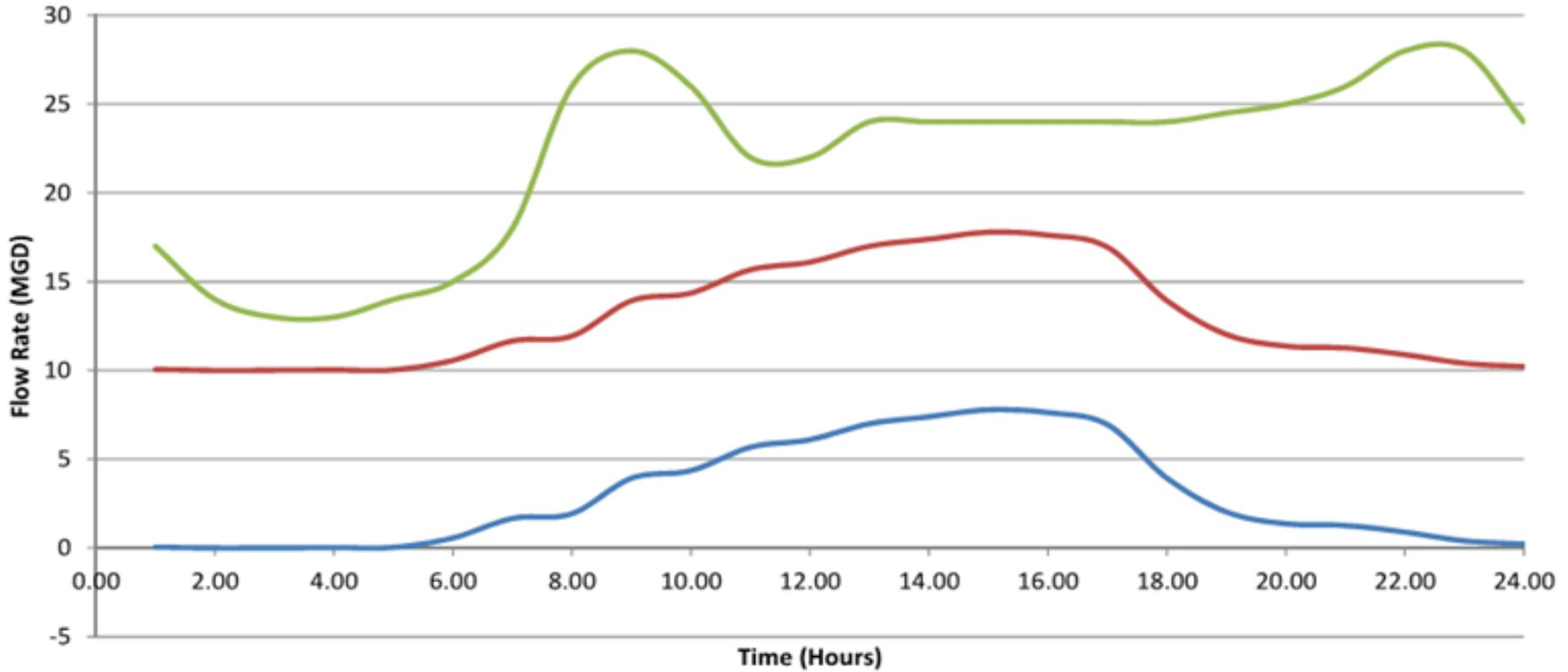
— Effluent Available      — Effluent Demand W/O Data Center      — Effluent Demand With Data Center
