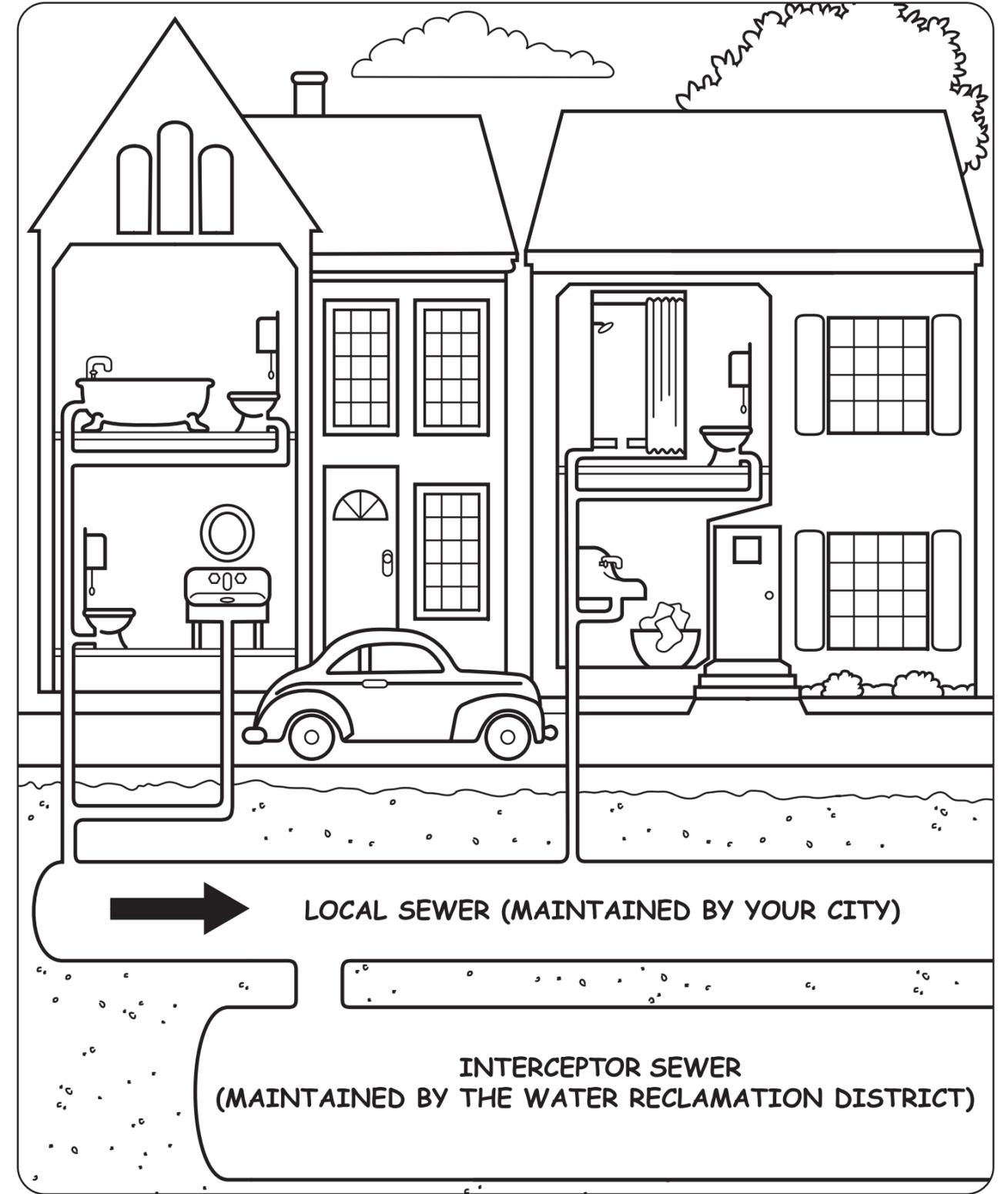
Cada vez que abres el grifo o descargas el inodoro, el agua baja por el desagüe y llega al alcantarillado local. El agua, a su vez, llega a la alcantarilla interceptora por donde corre hasta llegar a las plantas de tratamiento del Distrito. La primera planta se construyó en la década de 1920.
